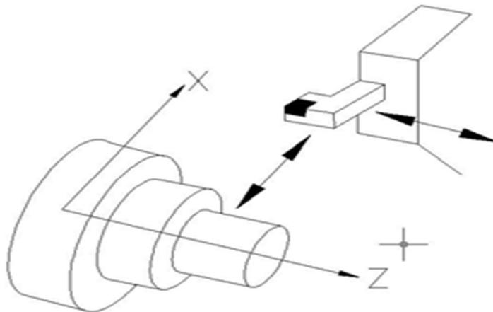
Fig 1. COORDINATE SYSTEM FOR TURNING OPERATIONS
